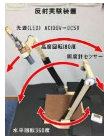
図-4 自作の反射実験装置
