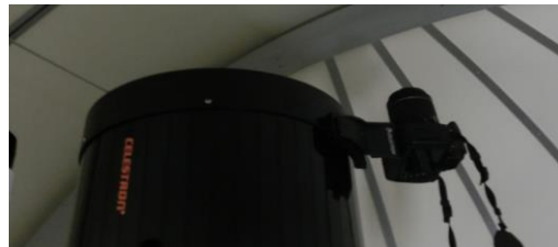
図 2. 赤道儀に取り付けたデジタルカメラ
