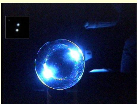
アクリル製重力レンズ。天体の重力場による重力レンズ現象を再現できる。左上の画像は、51cm望遠鏡で撮像した重力レンズ天体。
