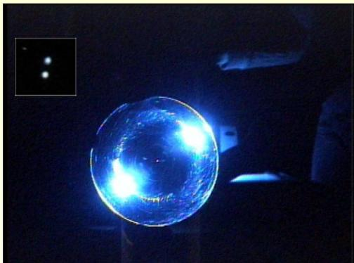
アクリル製重力レンズ。天体の重力場による重力レンズ現象を再現できる。左上の画像は、51cm望遠鏡で撮像した重力レンズ天体。
