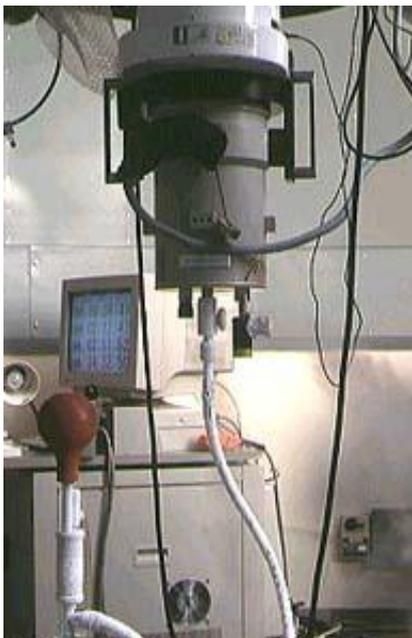
図 17 冷却 CCD カメラ。
