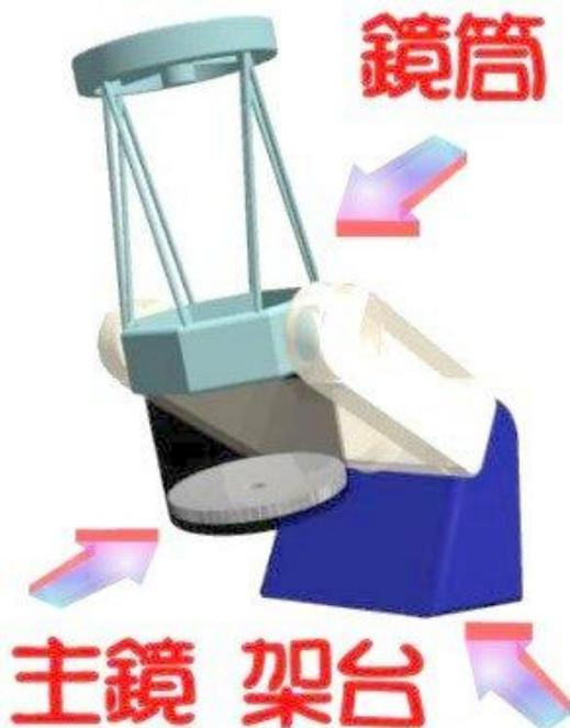
図13 望遠鏡の構造
