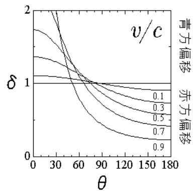
図 12 ドップラー因子  $\delta$ 。（上）角度  $\theta$  をいろいろ与えたとき、速度  $v$  の関数としてドップラー因子  $\delta$  の値。（下）速度  $v$  を与えたときの、角度  $\theta$  の関数としてドップラー因子  $\delta$  の値。
