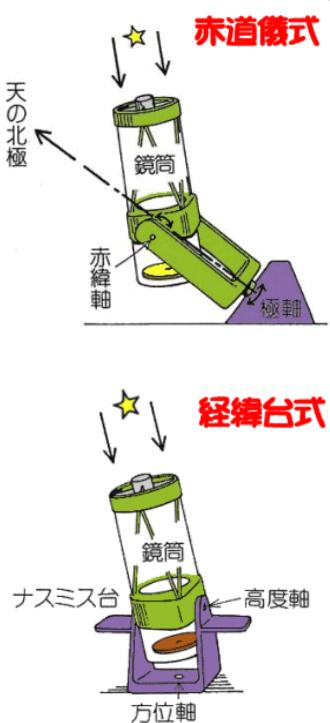
図 15 赤道儀式望遠鏡(上)と経緯台式望遠鏡(下)。
