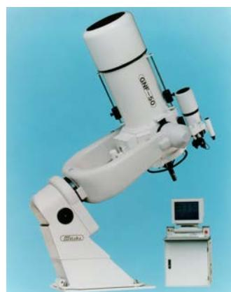
図20 口径51cmの反射望遠鏡(大阪教育大学)。
