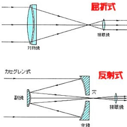
図 14 屈折望遠鏡（上）と反射望遠鏡（下）。
