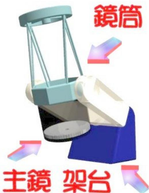
図 13 望遠鏡の構造
